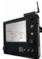
스마트 팩토리 원격진동/RPM 모니터링 장비 PA201-3CH-WMDFS
